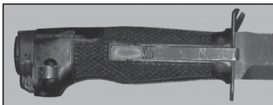
Фото 12. Сложный вариант рукоятки боевого ножа НРС-2 с вмонтированным в нее устройством бесшумной и беспламенной стрельбы
