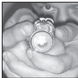
Фото 9. Упор боевого ножа НРС-2, используемый в качестве элемента прицельного приспособления
