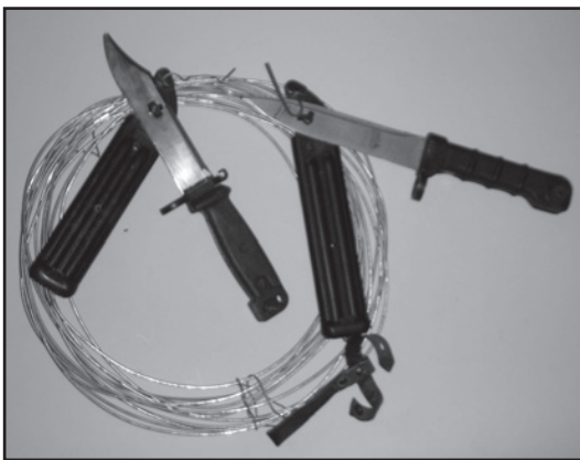
Фото 5. Монтаж штык-ножа с ножнами для резки проводов и проволоки
