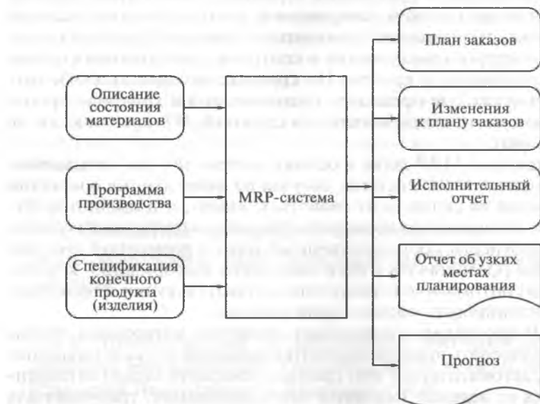
Рис. 5.6. Входные элементы и результаты работы MRP-системы производства
