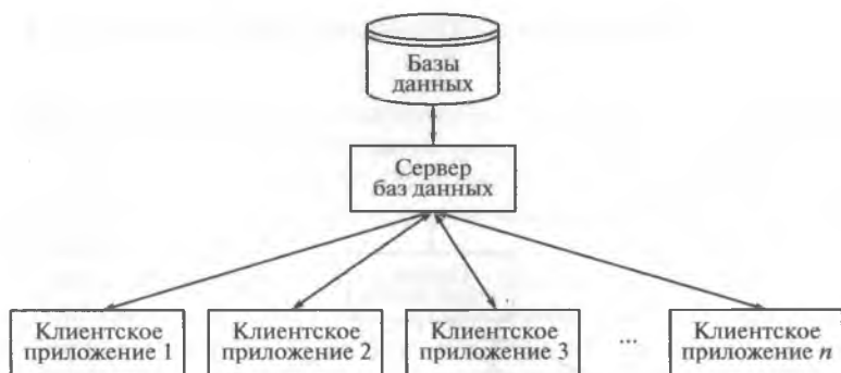
Рис. 1.7. Двухуровневая архитектура клиент-сервер
